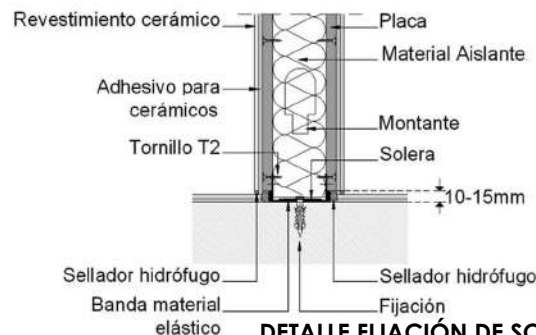
DETALLE FIJACIÓN DE SOLERA AMBIENTES HÚMEDOS
